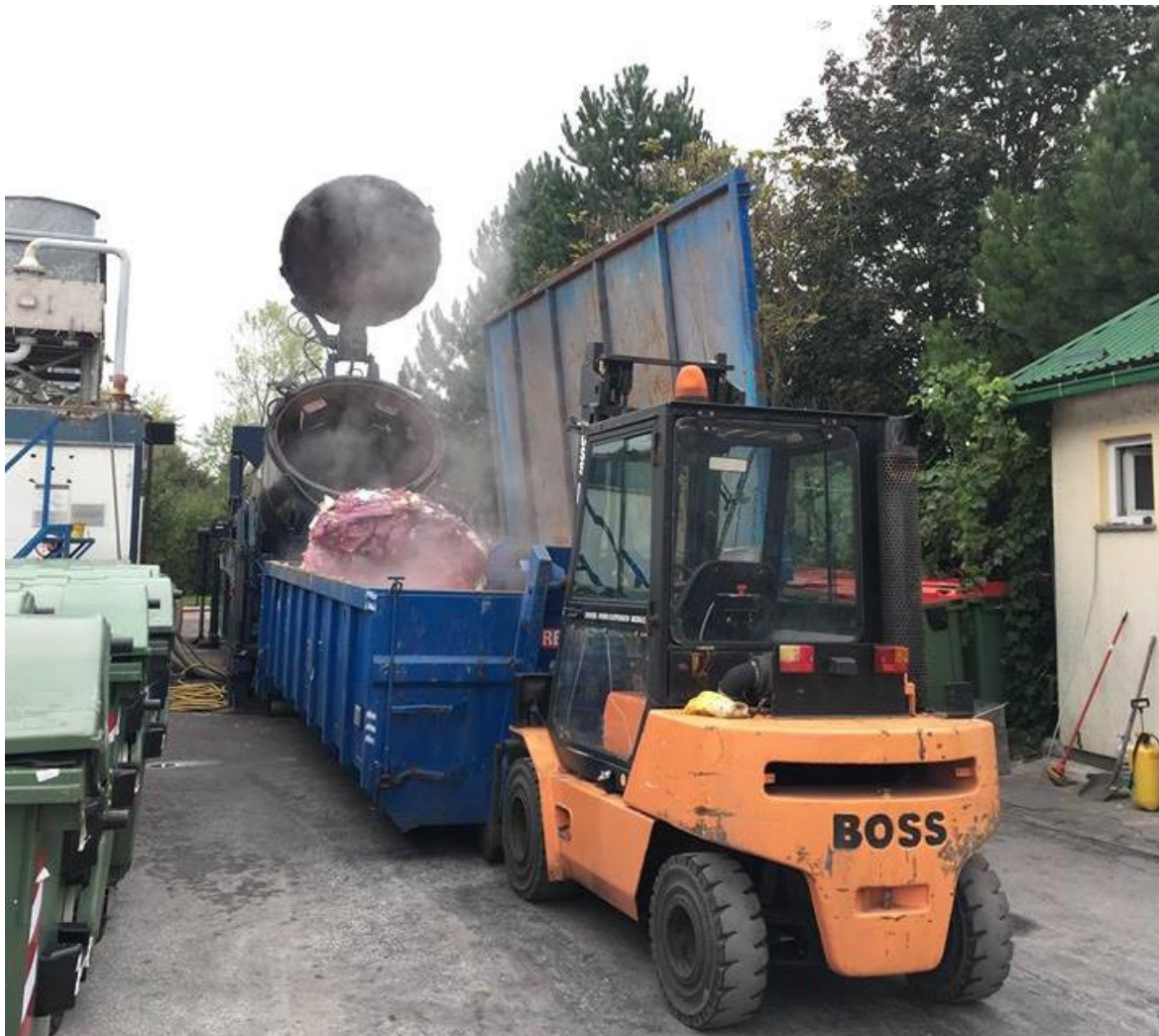
Fotografija A-5: Pražnjenje autoklava nakon završenog ciklusa obrade u prihvatni kontejner Izvor: REMONDIS Medison d. o. o.
